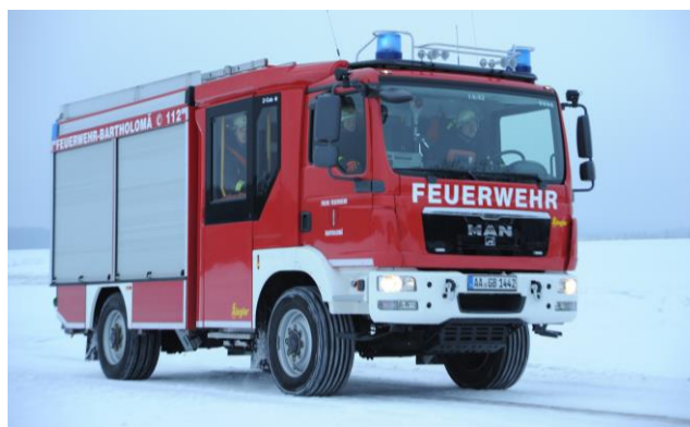
HLF 10 14/43: 1.000l Wasser, Rettungs- plattform, Mehrzweckzug, Hochdruckhebekissen
