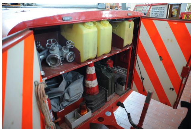
Tragkraftspritzenanhänger, 500m Schlauch fertig gekuppelt, TS 8/8, Faltbehälter Baujahr 1956 (umgebaut 2008)
