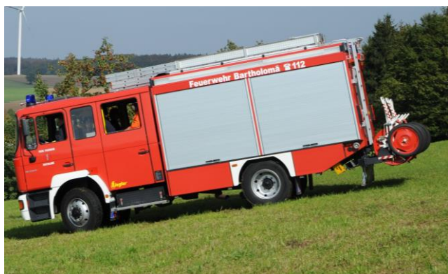
HLF 20 14/46: 1.600l Wasser, Schere, Spreizer, Sprungpolster, Luftheber
